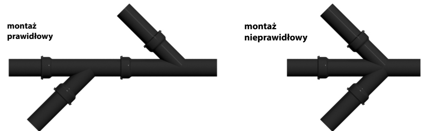
Rys.2 Instalacja pozioma - odgańlenie od głównego przewodu
